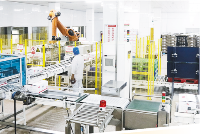
惠发食品应用冷链自动包装机包装丸类产品。
