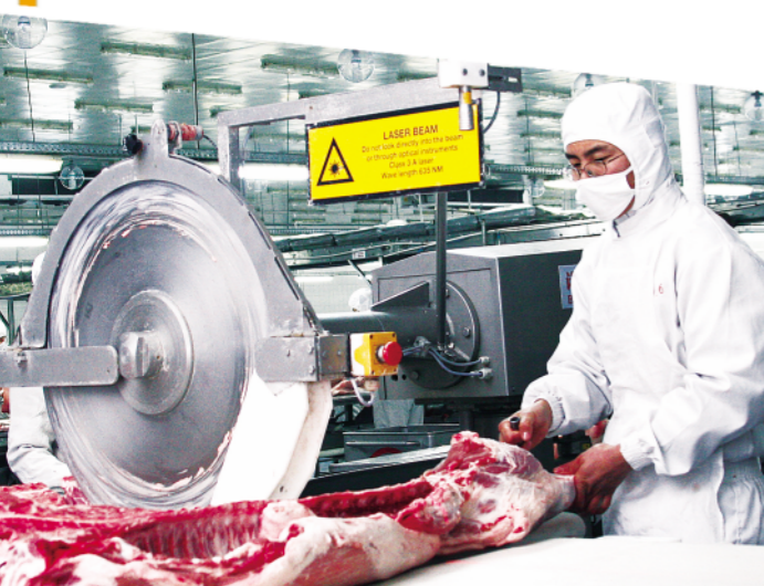
得利斯集团采用激光定位分割科学工艺加工肉制品。
