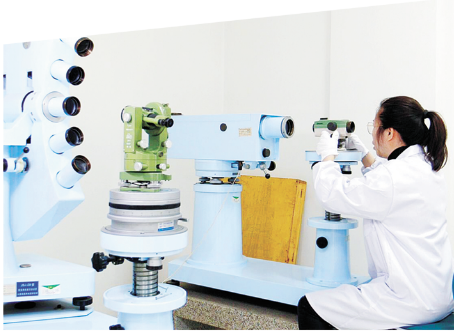
市计量技术研究院技术人员开展测绘用水准仪计量检定。
