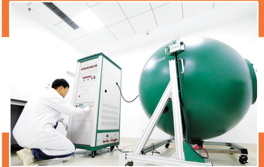
市计量技术研究院技术人员对总光通量标准白炽灯实施检定。
