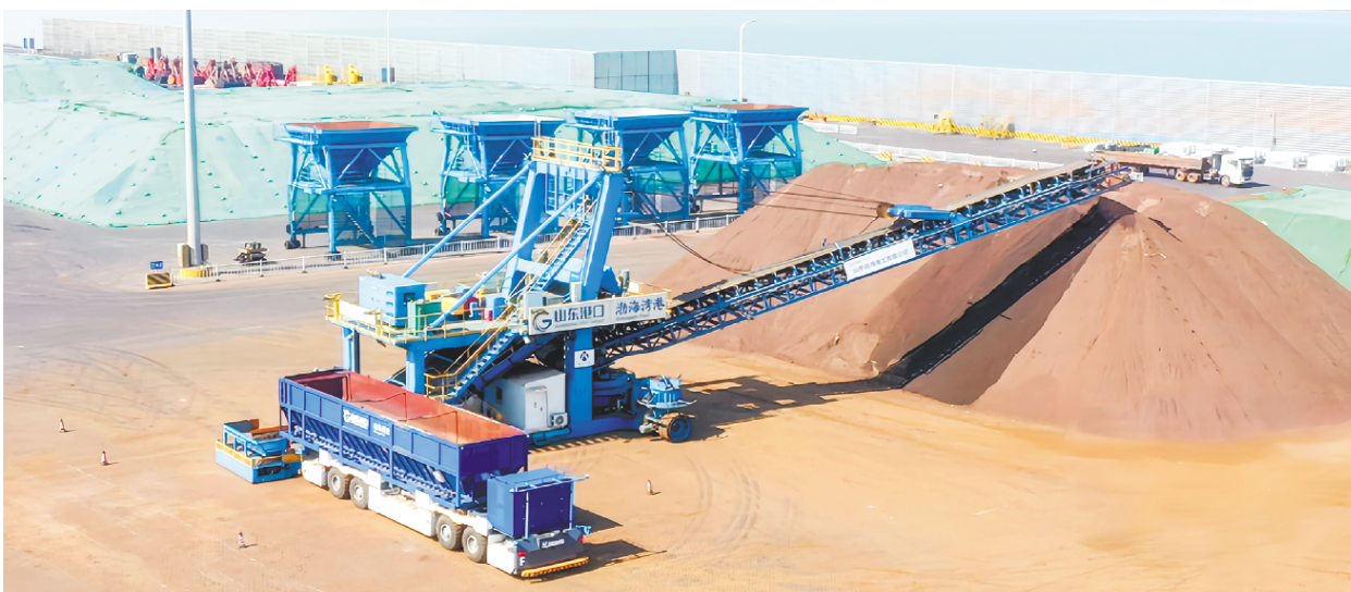
△潍坊港区全自动堆高机正在进行货物堆高打垛作业。通讯员 丁赞栋 摄
