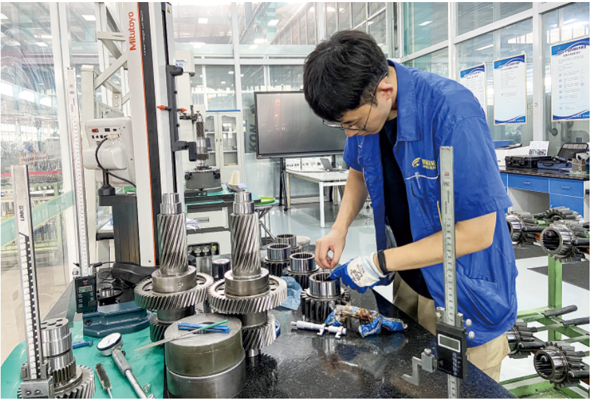
△工作人员正在对齿轮产品进行出厂前的检测。
