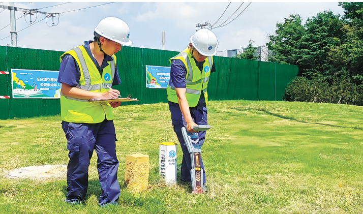
孙浩男(左),张云颂手持探管仪认真检测。
