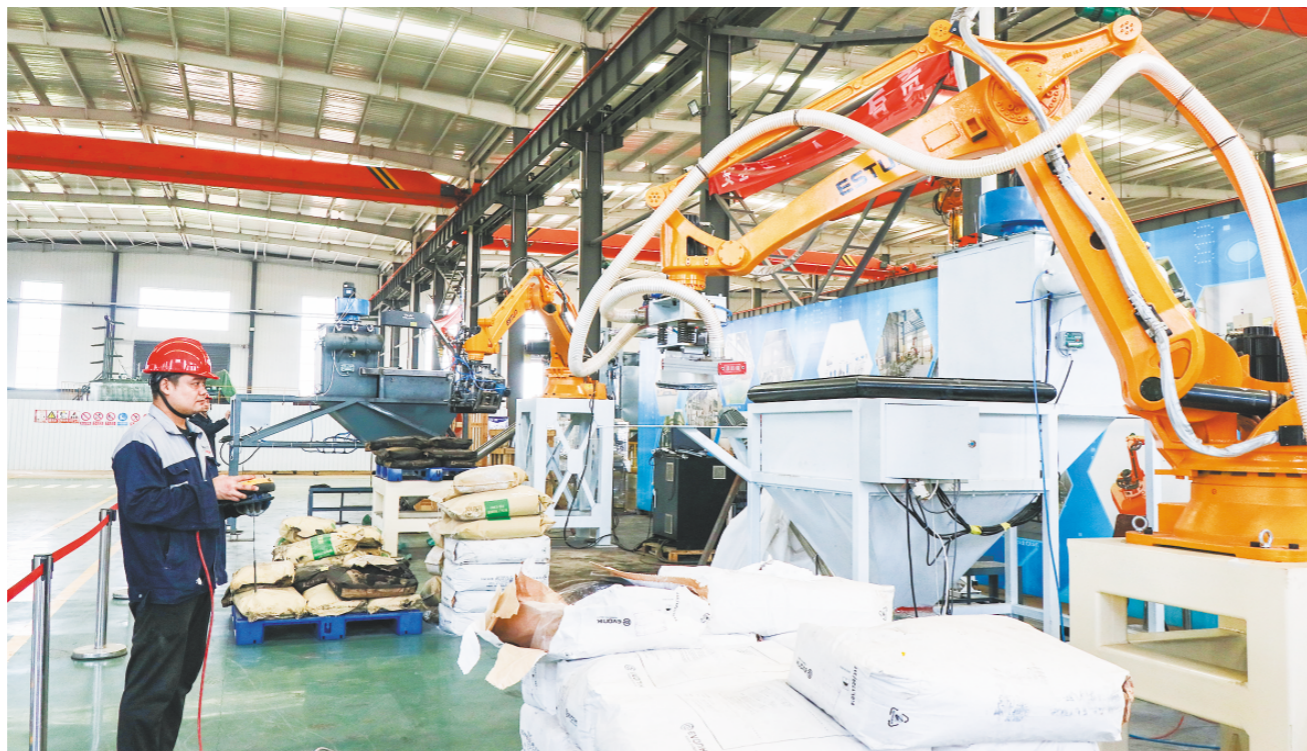
△安丘博阳机械制造有限公司工作人员在操控机器人拆装系统。
