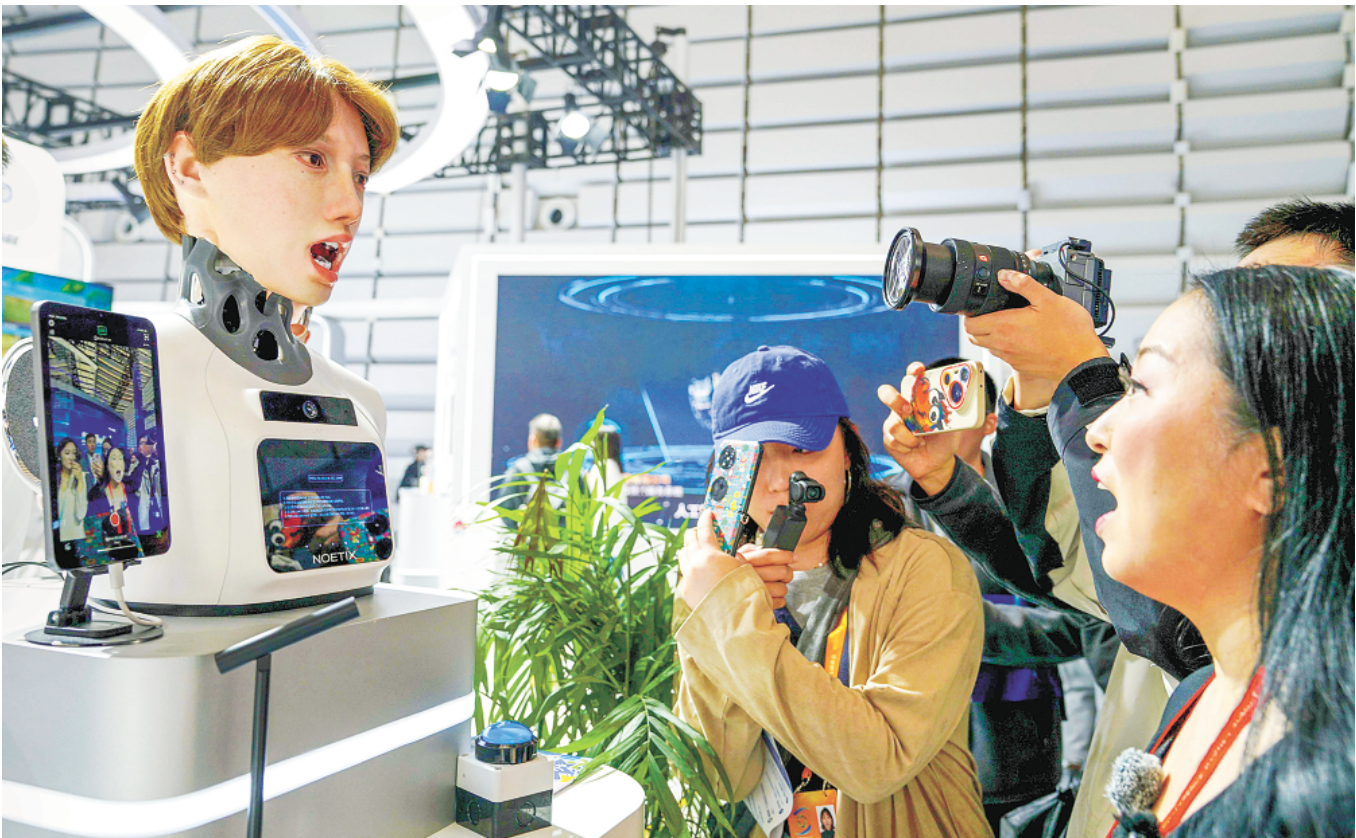
2025年11月6日，在浙江乌镇举行的世界互联网大会“互联网之光”博览会上，一名工作人员与仿生机器人互动。这款自主研发的仿生机器人可实时识别并模仿互动对象的各种面部表情。
