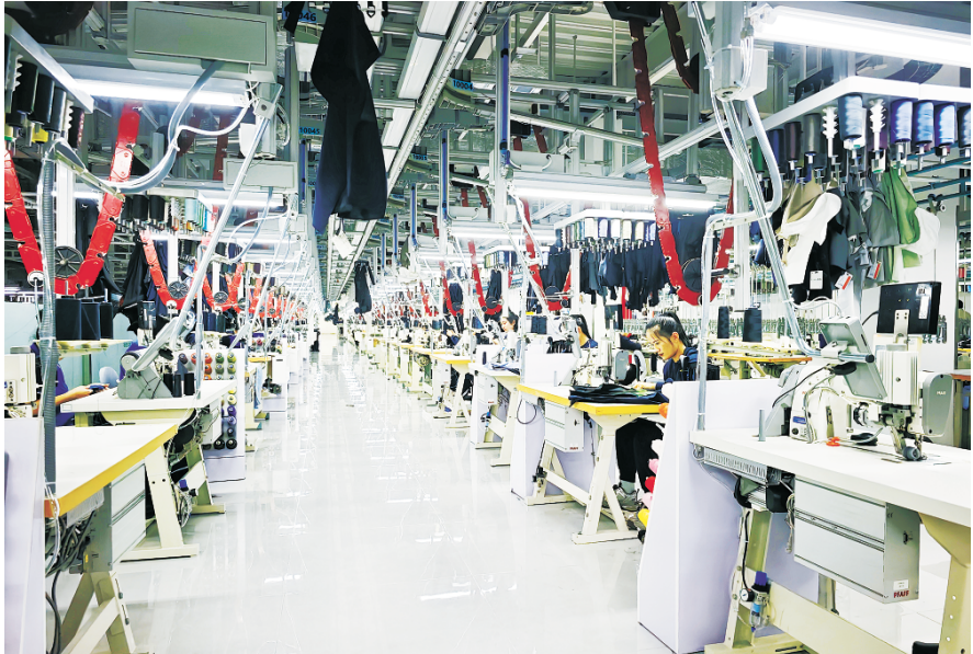
在酷特智能(山东)有限公司生产车间，一条条定制裤通过传送带流转在各制作环节间。
