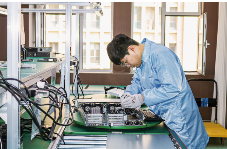
达成中科技术人员正在组装服务器。
